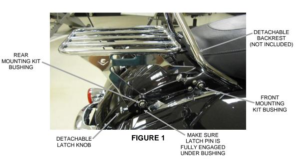
DO NOT EXCEED THE MAXIMUM WEIGHT OF THE RACK MAX WEIGHT CAPACITY OF RACK = 10 POUNDS.
